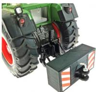
Heckgewicht Xenon mit Bolzenkupplung
