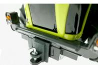
Frontkupplung mit Steckbolzen für Claas Xerion (6791,6794)
