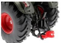
Adapter Heckkupplung mit Bolzen
