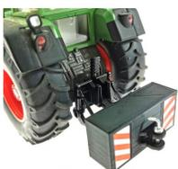
Heckgewicht Xenon mit Bolzenkupplung
