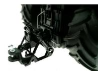
Anhängerkupplung mit Steckbolzen für Claas Xerion (6791,6794)
