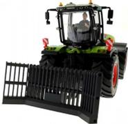
Gefächertes Silageschild für Claas Xerion (6791,6794)
