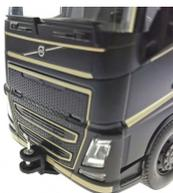
Frontkupplung mit Bolzen für Siku Control 32 LKW
