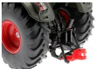
Adapter Heckkupplung mit Bolzen
