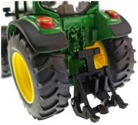
Ersatz Heckkupplung für Siku Traktoren 1:32
